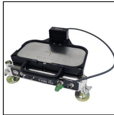
Plattform mit Kalibrierrahmen und um 180° gedrehtem Sturzsensor
