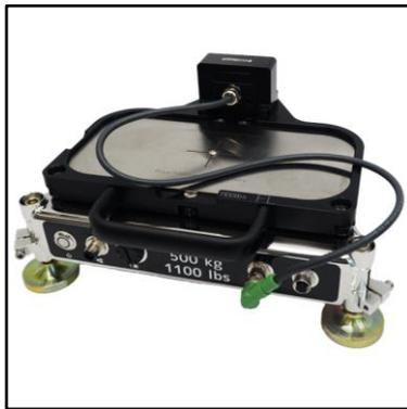
Plattform mit Kalibrierrahmen und Sturzsensor (Inklinometer)
