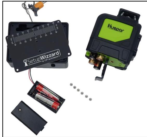
Der Nivellierlaser vom Typ „Huepar 901CG“ arbeitet ebenfalls mit vier Batteriezellen des Typs „AA“. Um diese zu wechseln, können Sie einfach das Batteriefach an der Unterseite des Nivellierlasers öffnen. Achten Sie auch hierbei auf die richtige Polung der Batterien!
