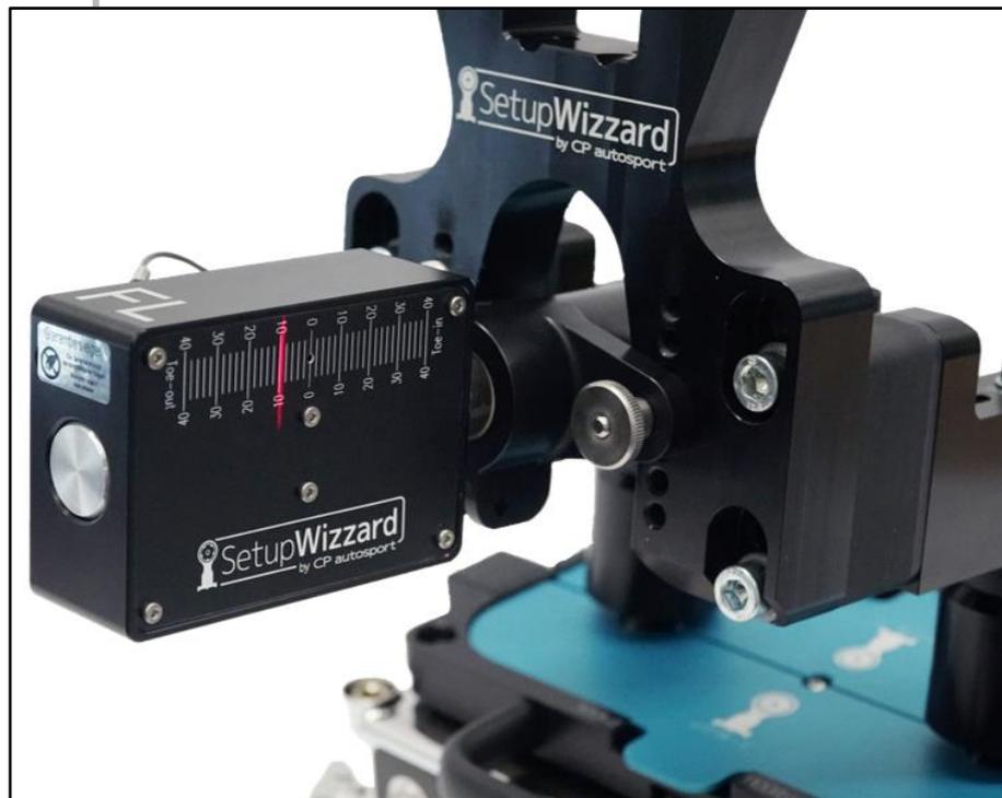
Die Spurmessmodule sind standardmäßig mit einer Millimeterskala ausgerüstet. Wichtig beim Ablesen der Werte ist, im mittleren Bereich vom Laserstrahl abzulesen. Wenn der Strahl zu weit nach oben oder unten gerichtet ist, kann es leichte Abweichungen ergeben.
