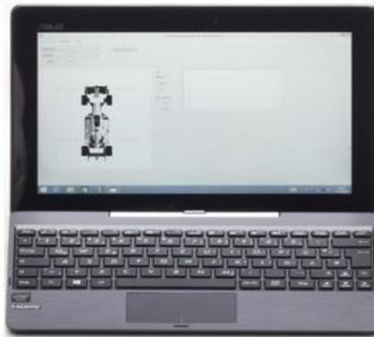
Die Software SetupWizzard ist auf dem mitgelieferten Netbook (kann von der Abbildung oben abweichen) bereits vorinstalliert. Sie starten das Programm durch Anklicken der Verknüpfung auf dem Desktop. Die von den Messplattformen per Funk übertragenen Daten werden von der Software verarbeitet und visualisiert.
